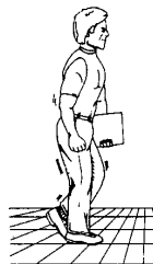
Laufen über einen unbehandelten Vinylbodenbelag, 250 bis 12 000 Volt
